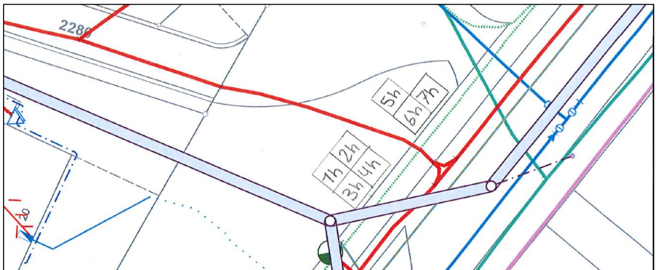
Wertstoffsammelstelle Badstrasse, Unterflurcontainer (1h – 8h) und bestehenden Werkleitungen
