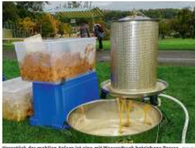
Herzstück der mobilen Anlage ist eine mit Wasserdruck betriebene Presse
