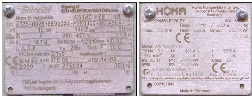
Abbildung 18: Typenschilder einer TW-Pumpe (links) und der RW-Pumpen (rechts)
