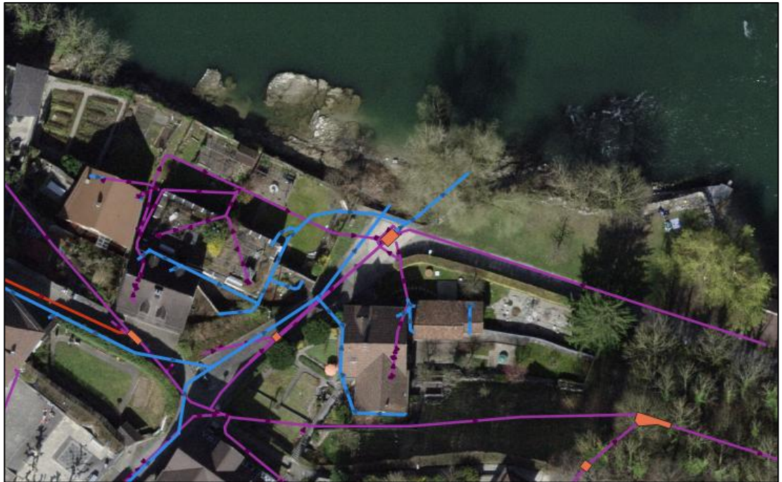
Abbildung 1: Leitungskataster und Sonderbauwerk PW Törlirain mit Luftbild
