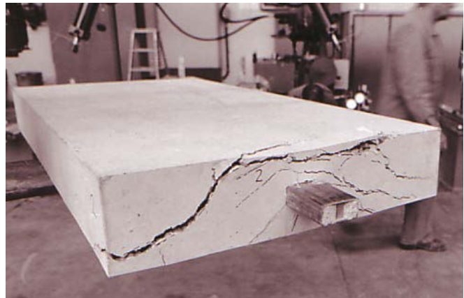
Platte mit Armierungsbügel und normaler Randbewehrung
