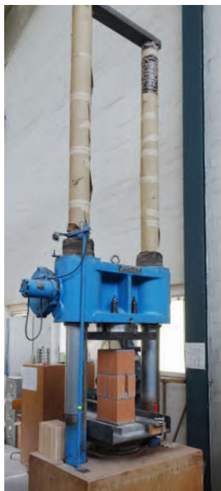
Druckfestigkeitsprüfung NUVO Wandlager mit Referenzsteinen
