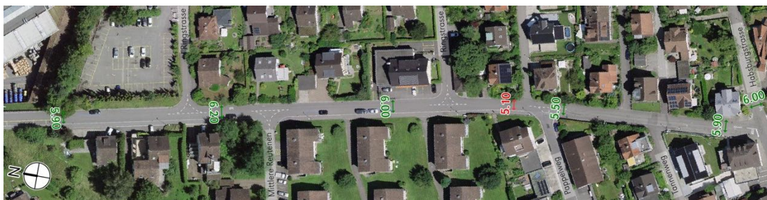
Abbildung 10: Luftbild Reutenenstrasse Abschnitt Nord mit Fahrbahnbreiten gemäss AV-Daten, rot = Grundbegegnungsfall nicht eingehalten (Luftbild swisstopo)
