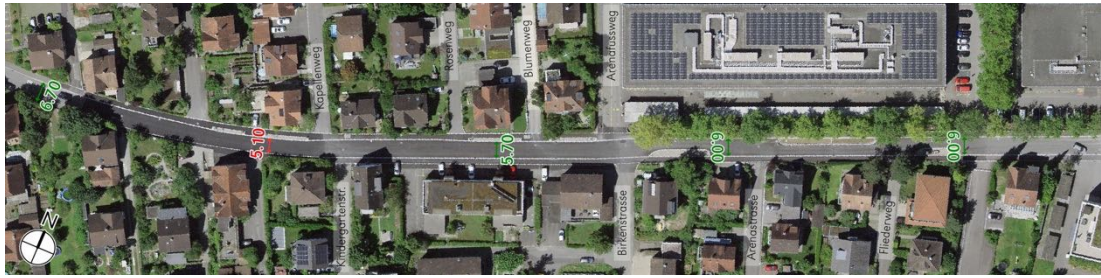
Abbildung 9: Luftbild Klosterzelgstrasse mit Fahrbahnbreiten gemäss AV-Daten, rot = Grundbegegnungsfall nicht eingehalten (Luftbild swisstopo)
