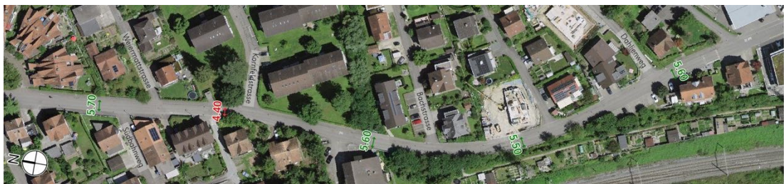
Abbildung 11: Luftbild Reutenenstrasse Abschnitt Süd mit Fahrbahnbreiten gemäss AV-Daten, rot = Grundbegegnungsfall nicht eingehalten (Luftbild swisstopo)
