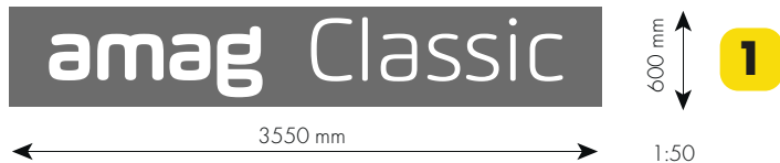
Aluminiumschild mit ausdecoupierten Buchstaben beleuchtet, Bautiefe 42 mm
