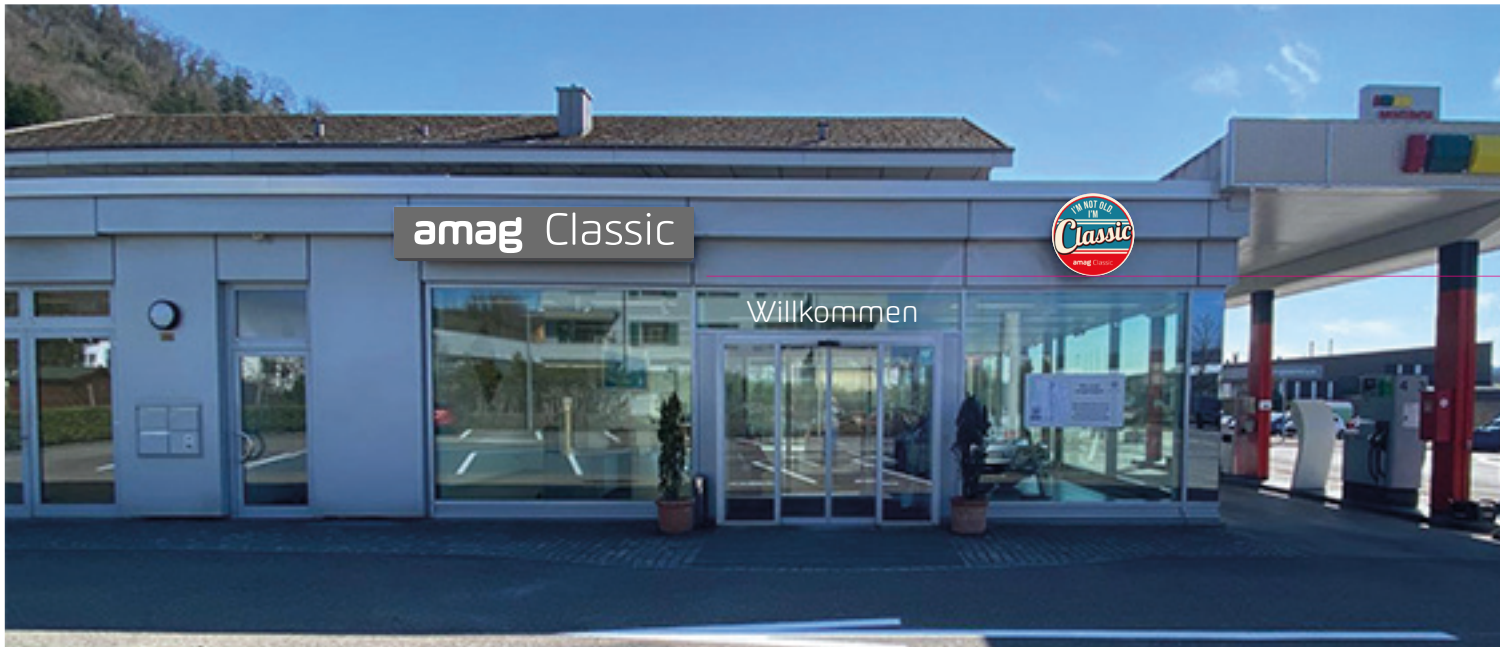
Aluminiumschild mit ausdecoupierten Buchstaben beleuchtet, Bautiefe 42 mm
